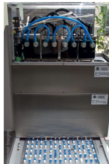
3CCD-Kameras in Kaskadenanordnung mit Wasserkühlung, integriert in einem Lynx-Spectra HR-System für die hochauflösende Farb-Produktkontrolle
