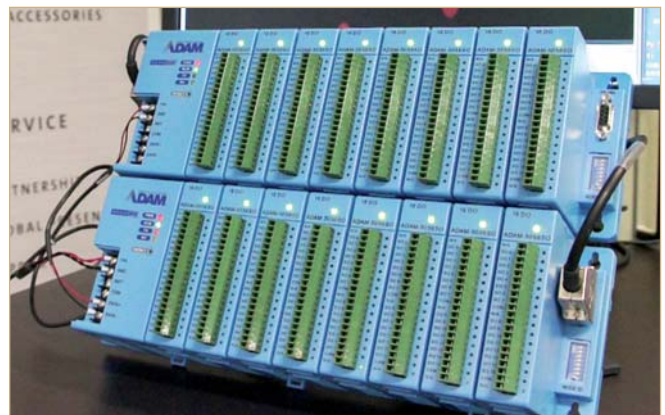
Über zwei Steuerungseinheiten können bis zu 256 Aktuatoren zum Ausstoßen der unerwünschten Teile angesteuert werden.
