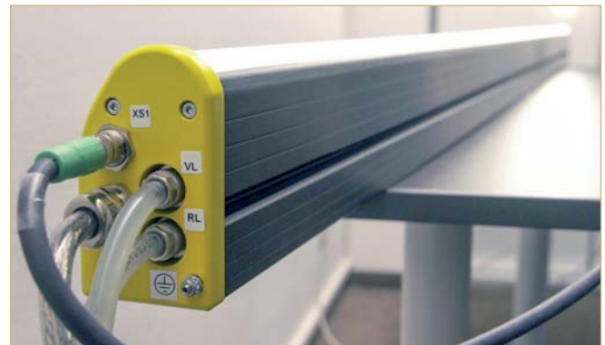
Die Ausleuchtung übernimmt eine 250 cm breite, wassergekühlte Zeilenbeleuchtung mit einer Leistung von 1440 Watt.
