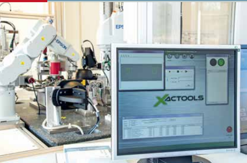
Die Auswahl der optimalen Bildverarbeitungs-komponenten sorgt für eine hochwertige Bildaufnahme. Eine vom Lauffener Systemintegrator Xactools entwickelte Nutzeroberfläche vereinfacht die Bedienung des Systems
