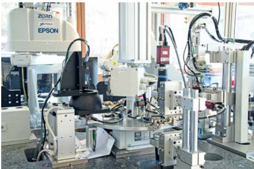
Sonderanlage von Zorn Maschinenbau, in der zahlreiche Automatisierungs- und Bildverarbeitungssysteme die Inspektion metallisch glänzender Bauteile mit unterschiedlicher Oberfläche ermöglichen, in diesem Fall von Hartmetallteilen
