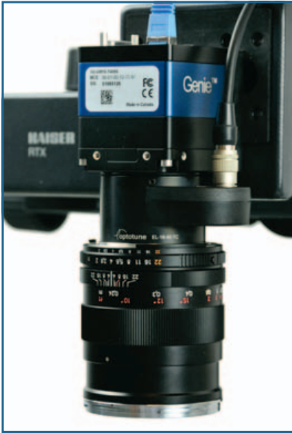
Das Optotune-Modell ,EL-16-40', eingebaut zwischen Kamera und Objektiv.
