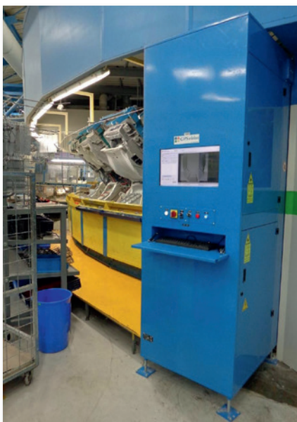
Ein in eine verkettete Fertigungslinie eingebautest Prüfsystem.
