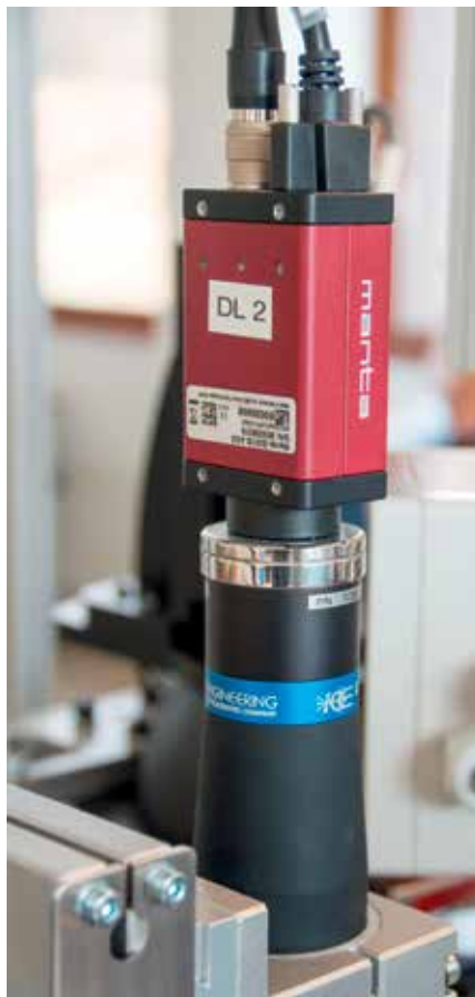
Bild 1. An einer Anlagenstation: präzise Bildaufnahme mit Kamera und telezentrischer Optik
