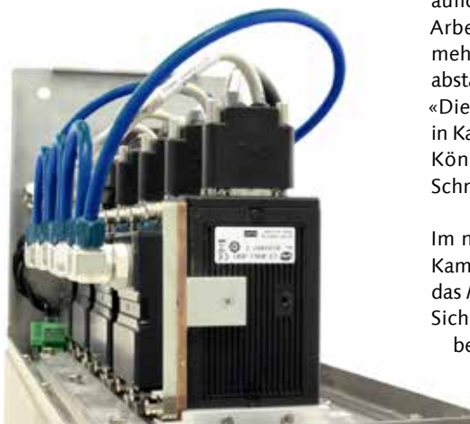
Die integrierte Wasserkühlung sorgt für eine optimale Arbeitstemperatur der Kameras.
