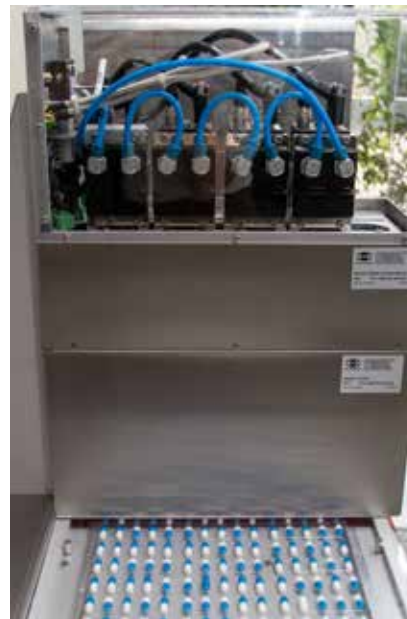
Mit bis zu sechs nebeneinander angeordneten 3CCD-Kameras vom Typ JAI CV-M9 CL überprüft die Scanware-Anlage die durchlaufenden Blisterbahnen auf Fehler.
