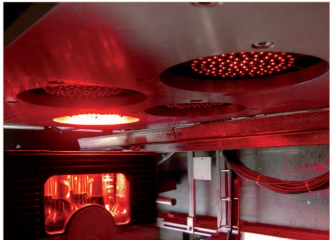
Durch eine zum Patent angemeldete, ultra-kompakte LED-Hochleistungs-Beleuchtung werden reliefartige Markierungen an den Flaschen besonders kontrastreich sichtbar.
