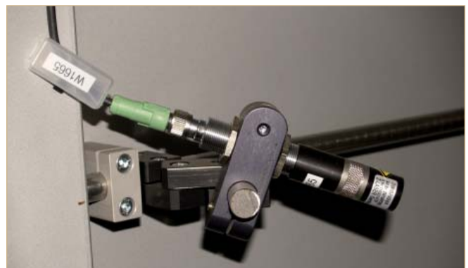
Einer der eingesetzten Linienlaser im Detail. Diese Beleuchtungen schaffen die Grundlage für die Erfassung von Prüfmerkmalen nach dem Triangulationsprinzip.
