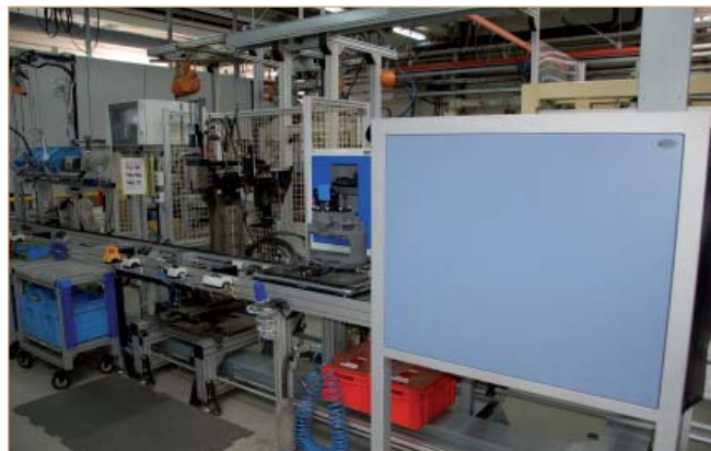
1.200 Scheibenbremsentypen mit 64 verschiedenen Prüfmerkmalen werden bei Knorr-Bremse über ein Bildverarbeitungssystem zu 100% inspiziert. Ein Förder-system bringt die auf Werkstückträgern montierten Bremsen in den Arbeitsraum der Prüfkabine.
