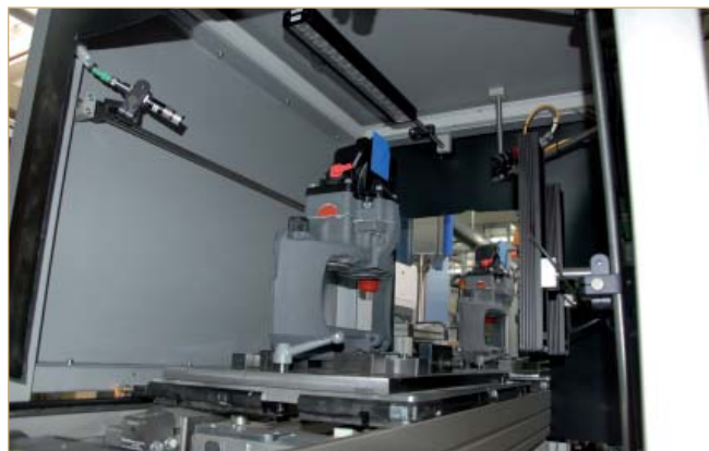
In der Prüfkabine sind drei Kameras, verschiedene Beleuchtungseinheiten und zwei Linienlaser im Einsatz.
