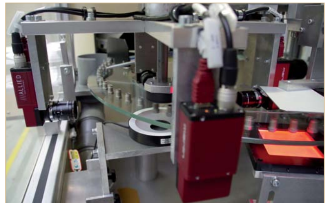
Vier Kameras an der letzten Prüfstation nehmen die Schrauben von allen Seiten auf. Rechts ist die geblitzte Beleuchtung der vorletzten Station erkennbar.
