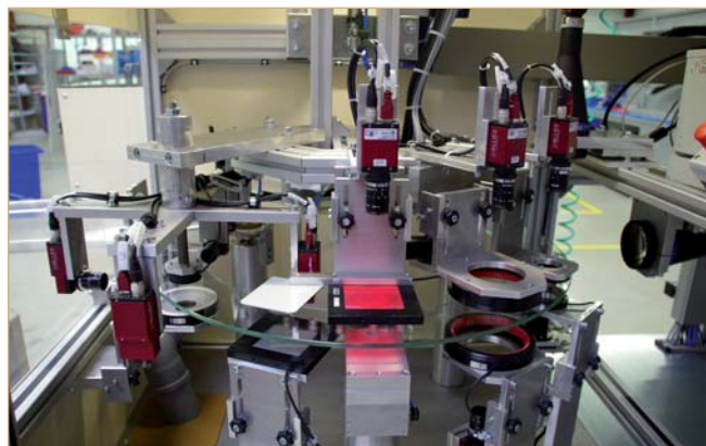
Zwölf Kameras an sechs Stationen sorgen für die sichere Erkennung fehlerhafter Teile.
