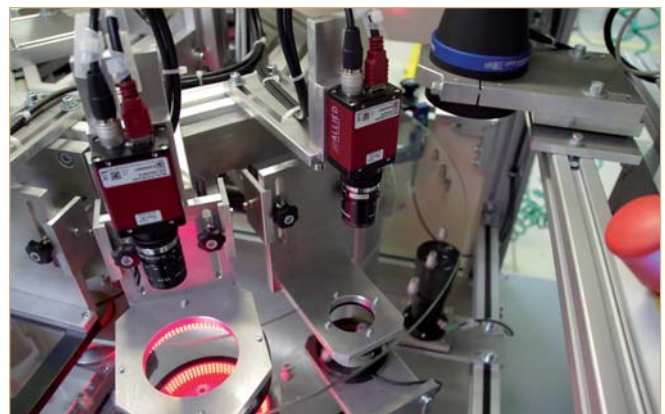
Die Prüfkörper werden auf einem Glasring transportiert und durchlaufen alle Stationen im Uhrzeigersinn.
