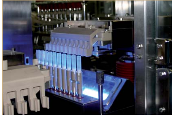
Avant d'être remplis, les tubes sont positionnés avec une précision de moins de 2 degrés.
