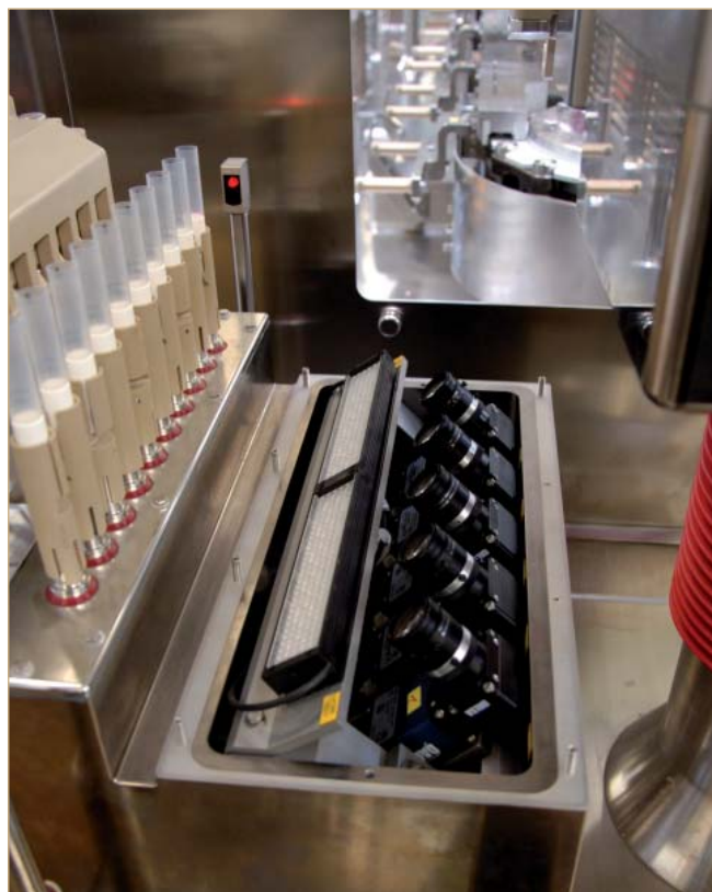
Le couvercle enlevé, on voit bien les cinq caméras DALSA Genie aux têtes coudées avec leurs objectifs ainsi que les deux champs lumineux à DEL.
