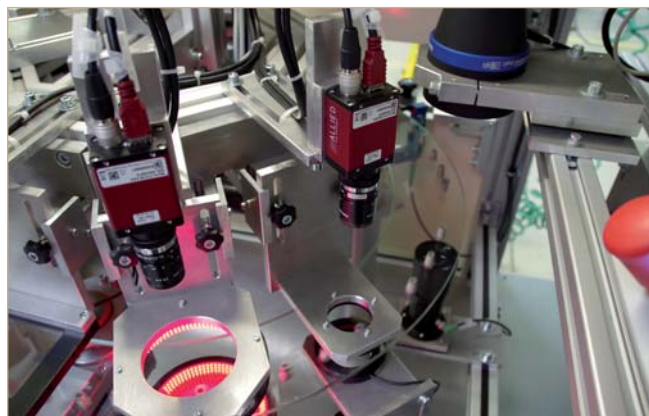
Les pièces à contrôler sont transportées sur un plateau de verre et passent par toutes les stations dans le sens des aiguilles d'une montre.
