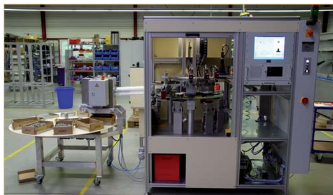
Aperçu de l'installation dans son intégralité dont l'habillage n'a pas encore été entièrement monté
