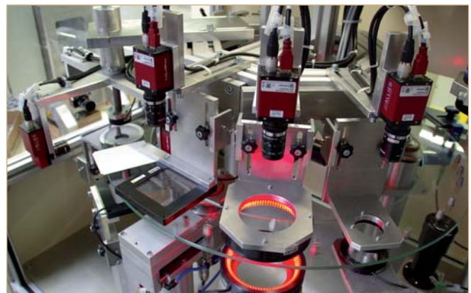
Les pièces sont examinées par le haut et par le bas sur quatre des cinq stations.
