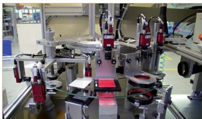
Les douze caméras des six stations permettent de détecter les pièces défectueuses en toute sécurité.
