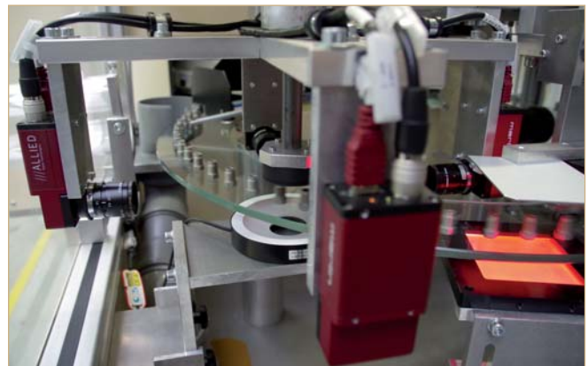
Les quatre caméras disposées sur la dernière station de contrôle analysent les vis sur toutes leurs faces. On peut voir à droite l'éclairage flash de l'avant-dernière station.
