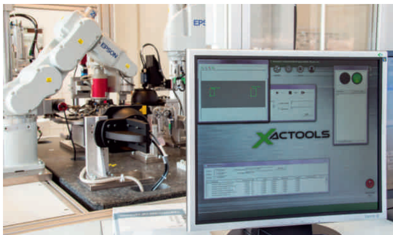
Die von Xactools entwickelte Nutzeroberfläche vereinfacht die Bedienung des Bildverarbeitungssystems in der Zorn-Anlage.
