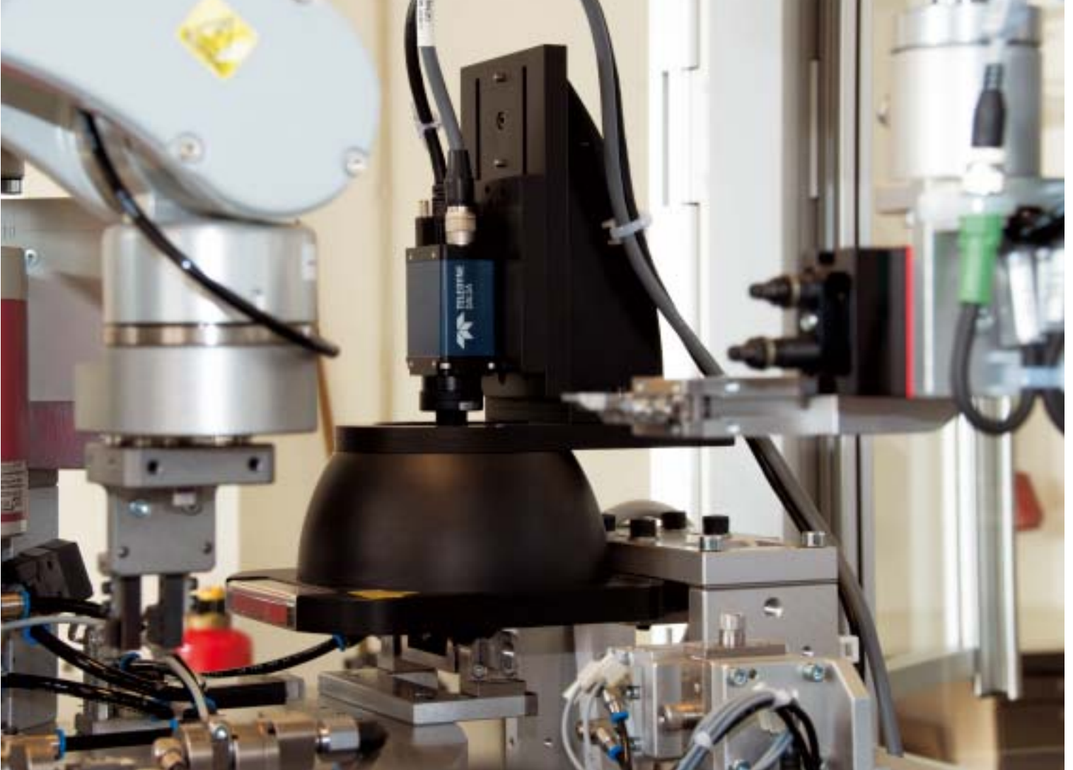
Die Anlage prüft Bauteile, die für Einspritzpumpen bestimmt sind
